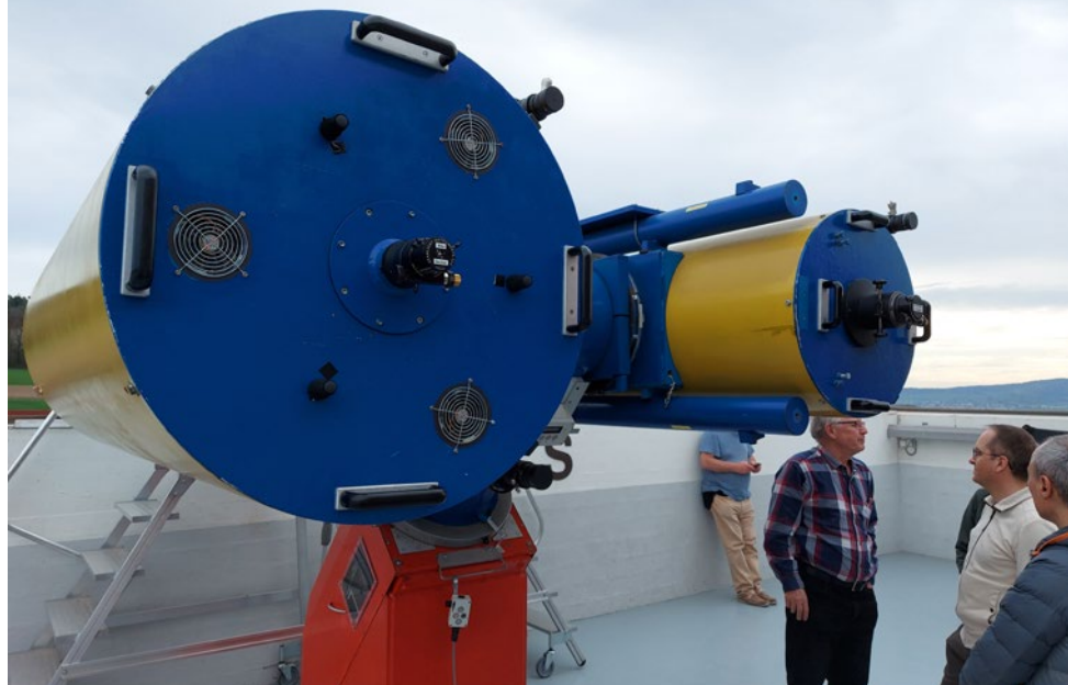
Abb. 5: Doppelteleskop auf der Sternwarte Bülach. 85 cm-Cassegrain (links) und 50 cm-Newton/Cassegrain. Die Montierung ist ein Eigenbau. - Foto: Rainer Glawion
