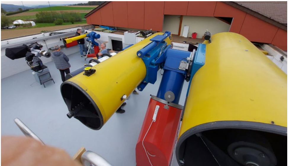
Abb. 4: Sternwarte Bülach. V.r.n.l.: 85 cm-Cassegrain, 50 cm-Newton/Cassegrain, Zeiss-Codé-Refraktor, 36 cm-Ritchey-Chrétien-Astrograf. - Foto: Rainer Glawion
