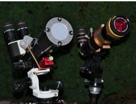
Abb. 3: Teleskop zur Sonnenbeobachtung im Weißlicht mit Folienfilter (links) und Spezialteleskop zur Sonnenbeobachtung mit H $\alpha$ -Filter (rechts).
