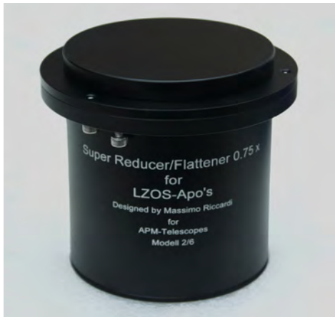
↑ Abb. 3: Riccardi Reducer 0,75x Effektive Brennweite: 900 mm bei f/5,9 Backfokus zum CCD: 70,6 mm, Anschlussgewinde: M82 x 1 i
