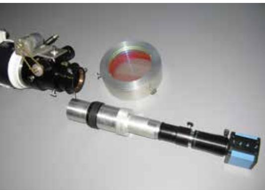
**Abb. 3: Etalon mit Zwischenoptik sowie das Block-Filter in gestrecktem Strahlengang**
