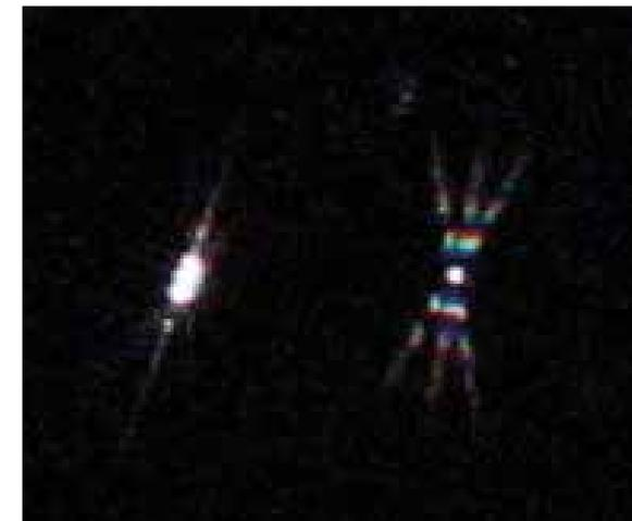
**Abb. 1:** Vergleich Bahtinov- (links) und Cuzdy-Maske (rechts) an einem schwachen Stern, identische Aufnahmedaten
