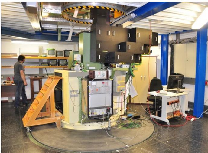
Abb. 5: Beobachtungsraum des VTT mit dem oberen Ende des Spektrographen (gelb und grün). Der schwarze Kasten beherbergt ein 3-Kanal-Kamerasystem für Spaltbilder, mit 2 Lyot-Filtern für  $H\alpha$  und für Ca-K sowie einem Interferenzfilter für den grünen Spektralbereich (Aufn. W. Schmidt).
