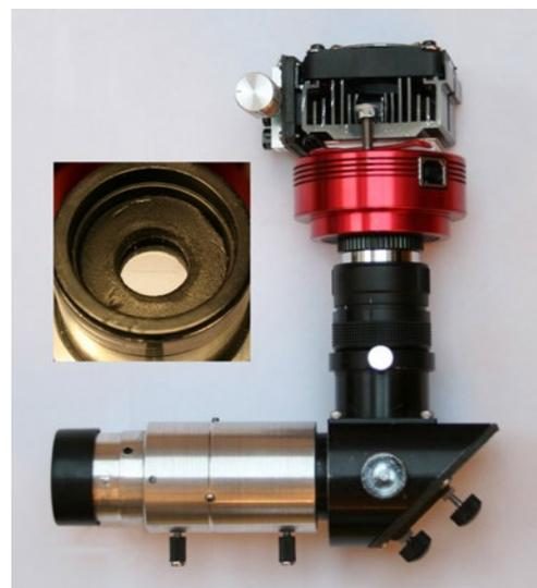
Abb. 1: Erste Version des Spektrographen, links der Spiegel mit Spalt
